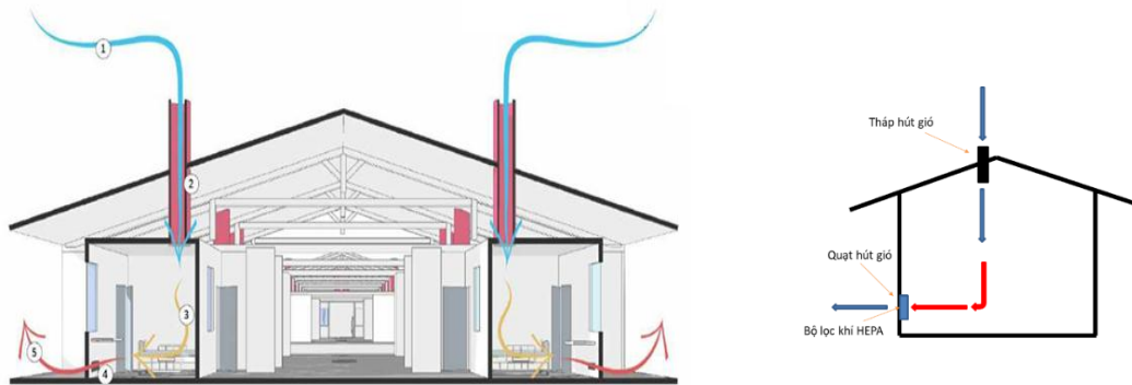
Hình 9. Mô hình thông khí phối hợp và sơ đồ xử lý khí thải
